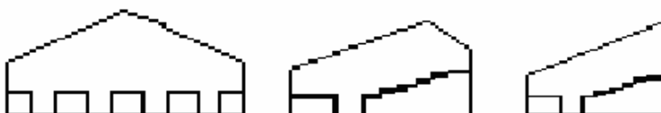
شکل ۱-۱ انواع سقف گلخانه، راست یک‌طرفه، وسط نیمه دوطرفه و چپ دوطرفه
