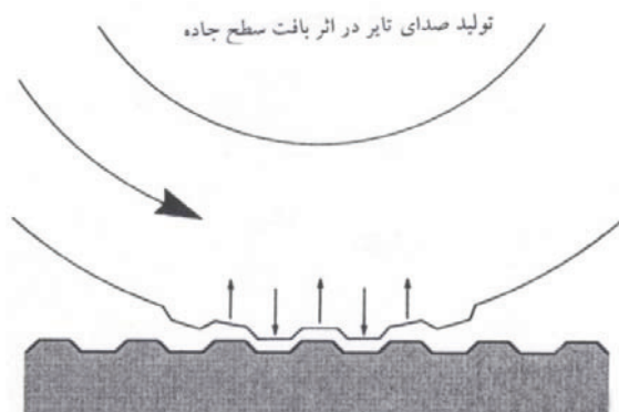
شکل ۳-۱- مکانسیم تولید صدا اثر تماس تایر و جاده
