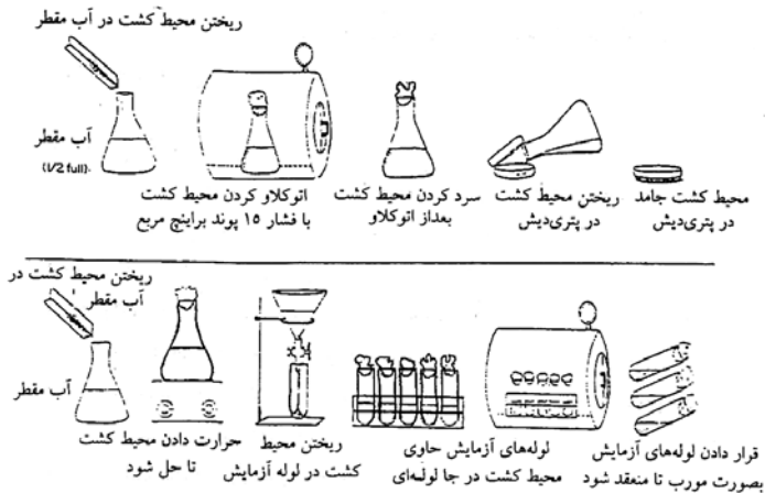
شکل ۱. طرز تهیه محیط کشت و ریختن آن در تشتک پتری و لوله آزمایش
