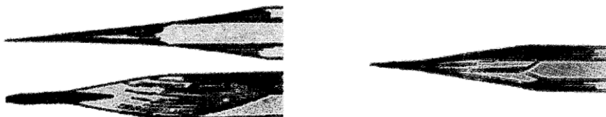
شکل ۲-۴. نوک تراشیده شده که به کمک کاغذ سنباده تخت شده است
