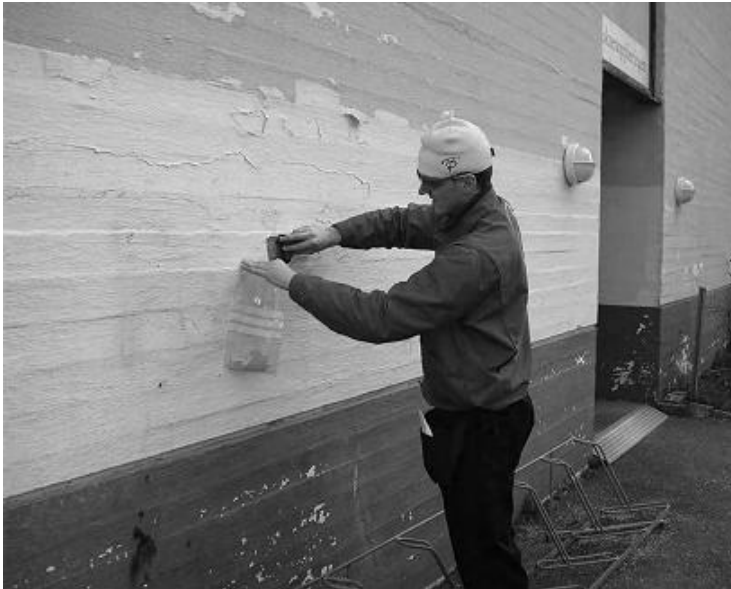
شکل ۵-۶. نمونه‌برداری از برخی محصولات که احتمالاً منشأ مهم آلودگی در محیط‌های شهری هستند. در این شکل، پوسته نازکی از رنگ نقاشی شده یک ساختمان در شهر اسلو نورژ به‌عنوان نمونه انتخاب شده‌است (یارتون و اوتسن، ۲۰۱۱).
