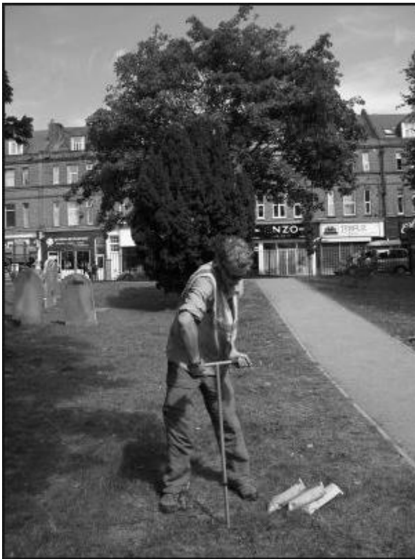
شکل ۵-۵. نمونه‌برداری سطحی از خاک. در مطالعات ژئوشیمی مناطق شهری اغلب از خاک‌های سطحی پارک‌ها، باغات، زمین‌های بازی و نهرآب‌ها نمونه‌برداری می‌شود. اگر هدف فقط نمونه‌برداری خاک باشد، معمولاً گیاهان مورد استفاده قرار نمی‌گیرند (عکس از سازمان زمین‌شناسی بریتانیا به آدرس اینترنتی http://www.bgs.ac.uk/gbase/urban.html ).
