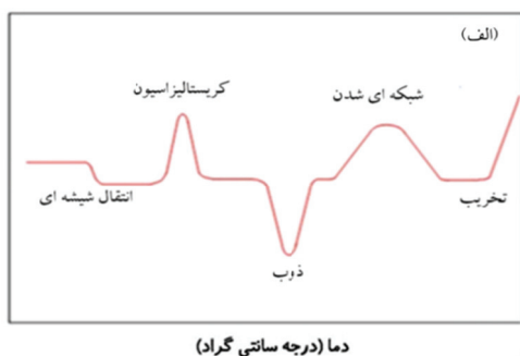
شکل ۱-۴. (الف) انواع انتقالات فازی در نمودار آنالیز حرارتی تفاضلی؛ (ب) تغییرات دمایی نمونه و مرجع هنگام انتقالات فازی
