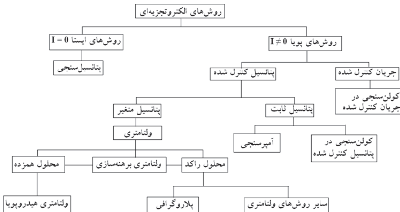
شکل ۱-۱. طبقه‌بندی روش‌های الکتروتجزیه‌ای (هریک از این اصطلاحات در مباحث بعدی شرح داده خواهد شد) (هاروی ۱ ۲۰۰۰).
