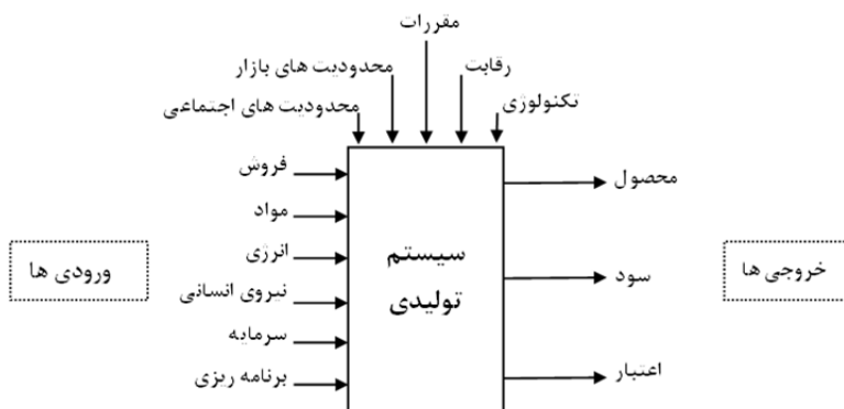
شکل ۱-۲. ورودی‌ها و خروجی‌های سیستم تولیدی
