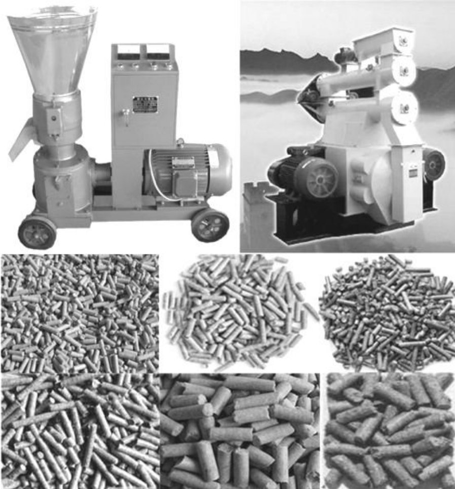
شکل ۱-۹. یک ماشین اکستروکننده و محصولات تولیدی آن
