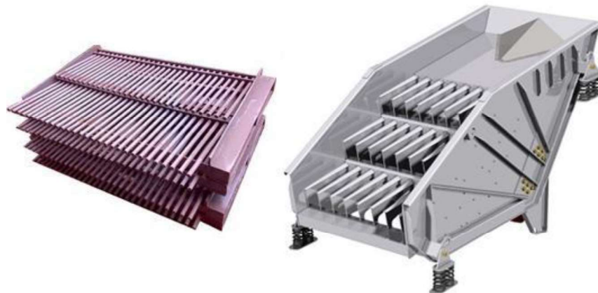
شکل ۱-۳. غربال میله‌ای (گریزلی) چند طبقه جهت دانه‌بندی بیشتر
