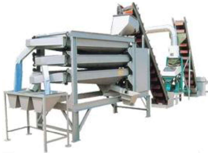
شکل ۱-۱۲. یک درجه‌بندی‌کننده بادام زمینی
