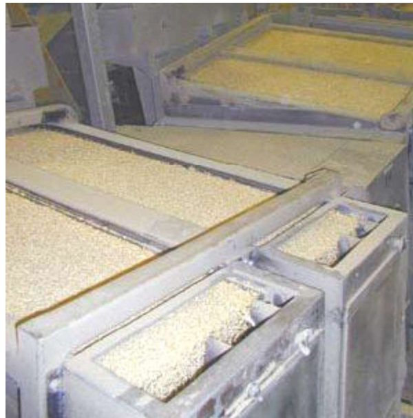
شکل ۱-۱۱. تمیزکننده دو غربالی دستی برای دانه‌های غلات
