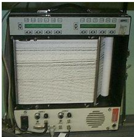
شکل ۲۲-۳. نمونه‌ای از چاپگر حرارتی
