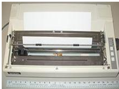
شکل ۲۰-۳. نمونه ای از دستگاه چاپگر ماتریس سوزنی
